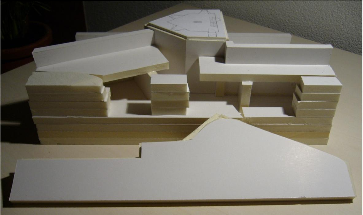
Nachdem die Schanzenmauerabschnitte montiert waren, wurden Abschnitte von 10 mm starken Platten aufgeschichtet, um das erforderliche Niveau zu erreichen.
